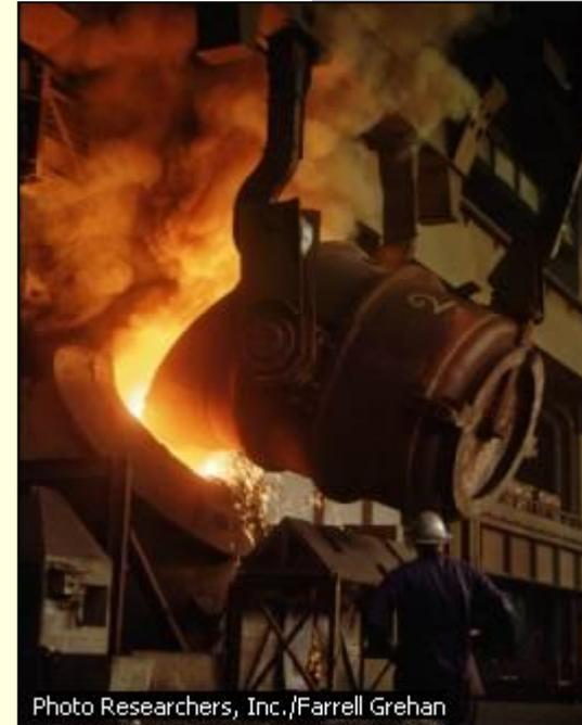
El arrabio fundido se vierte en un crisol abierto para ser convertido en acero.
