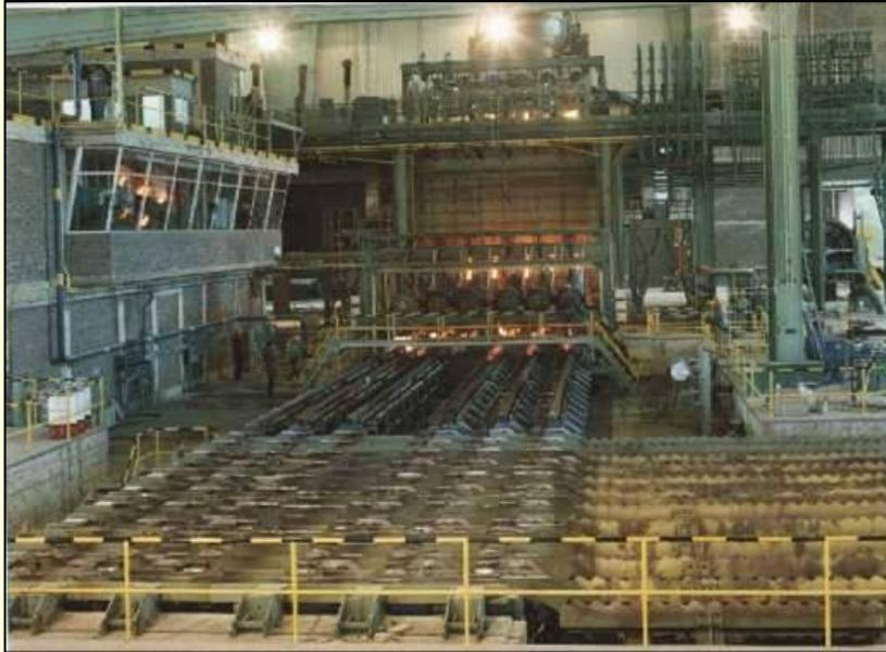
**El acero líquido se traslada desde el horno a un depósito que alimenta un flujo continuo de metal a la temperatura deseada para su laminación.**
