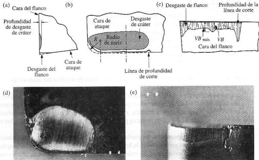
**FIGURA 20.15** (a) Desgaste de flanco y de cráter, en una herramienta de corte. Esta herramienta se mueve hacia la izquierda. (b) Vista de la cara de ataque de un buril de torneado, mostrando el radio de nariz  $R$  y la figura de desgaste de cráter en esa cara de ataque. (c) Vista de la cara de flanco de un buril de torneado, mostrando la pista de desgaste promedio del flanco ( $VB$ ) y la línea de profundidad de corte (muesca de desgaste). Fuente: J. C. Keefe, Lehigh University.
