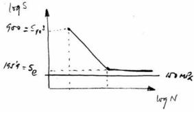
Como se observa en le gráfica, no a necessio interpolar. La place tralega con vite infinitz.
