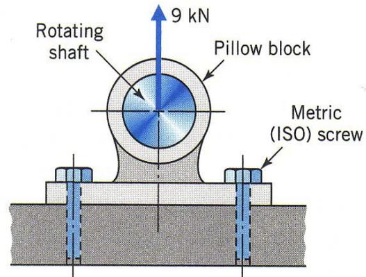
Primeramente, conviene recordar que la fuerza de 9 kN se reparte entre los dos tornillos. Debido a la simetría, cada tornillo se cargará con 4,5 kN.
