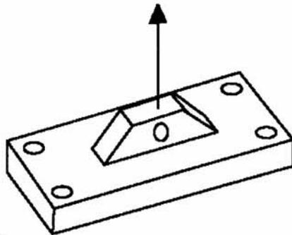
a) La carga máxima que soportará cada tornillo será de 750 kg. La precarga necesaria para que el soporte no se separe del suelo lo calculamos haciendo
