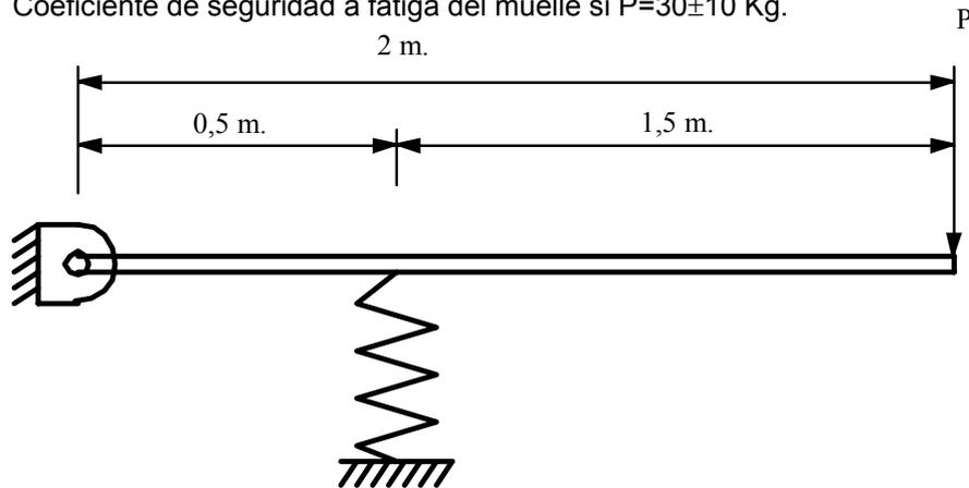
*Mediante compatibilidad de desplazamientos se relaciona el movimiento del resorte con el extremo de la barra.*
