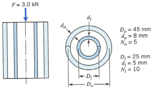
Datos:  $G=800.000 \text{ Kp/cm}^2$ ,  $K = \frac{Gd^4}{8D^3Na}$ , Resistencia a la deformación permanente  $S_T=600 \text{ MPa}$  y Resistencia a la Fatiga Repetida  $S_{FR}=500 \text{ MPa}$ .
