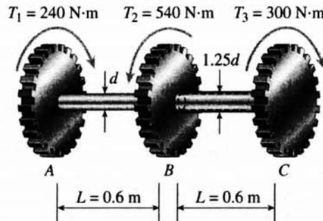
En primer lugar dibujamos el diagrama de momentos torsionales en la barra. Por otro lado, lo que varía de una sección característica a otra es el momento de inercia polar
