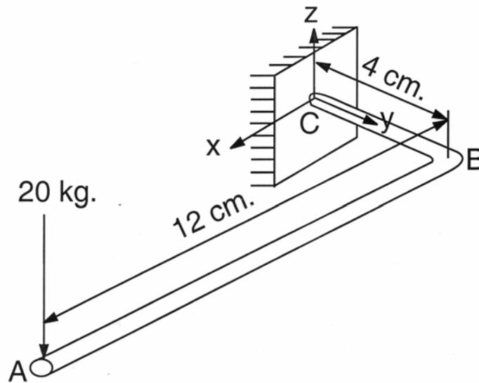
Una posibilidad es resolver el ejercicio aplicando el principio de superposición de esfuerzos. De esta manera podemos estudiar el tramo AB por un lado, como si se tratase de una viga empotrada en un extremo y con el otro en voladizo, y por otro lado el tramo BC.
