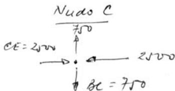
$$\boxed{\begin{array}{l} CE = 2500 \text{ N a Compresión} \\ BC = 750 \text{ N a Tracción} \end{array}}$$
