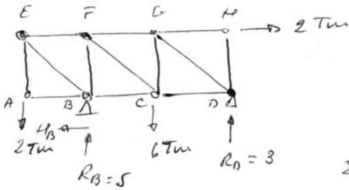
En primer lugar se calculan las reacciones en B y D mediante las ecuaciones de la estática.
