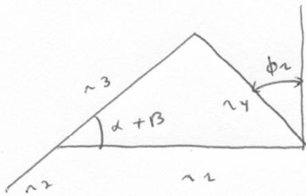
$$(r_3 - r_2) \cos(\alpha + \beta) + r_4 \sin \phi_1 = r_2$$
