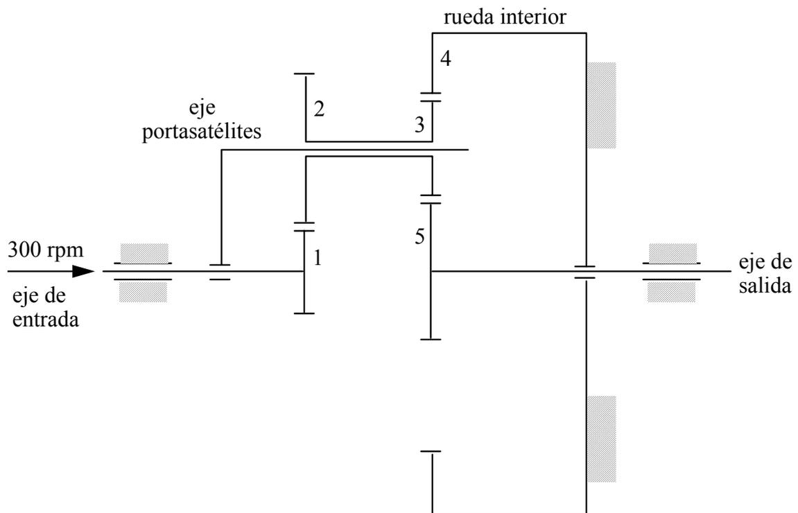
$$a) R_5 + 2R_3 = R_4 \Rightarrow \frac{u z_5}{2} + 2 \frac{u z_3}{2} = \frac{u z_4}{2}$$
