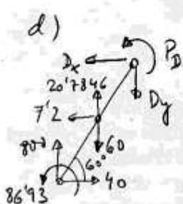
$$\begin{cases} \vec{F}_{in} = -\omega_t \vec{a}_c = -6 \begin{Bmatrix} 1'2 \\ -3'4641 \end{Bmatrix} = \begin{Bmatrix} -7'2 \\ 20'7846 \end{Bmatrix} \\ \vec{N}_{in} = \vec{0} \end{cases}$$
