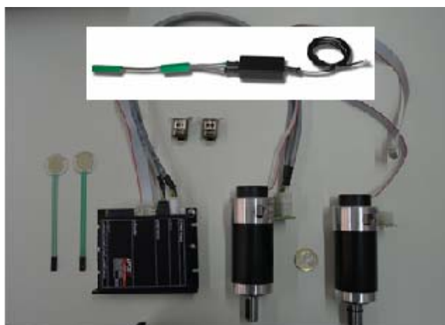
Figura 2. Componentes para el control de la ortesis.
