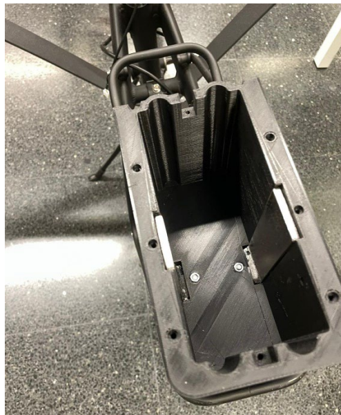
Figura 4: Alojamiento de la batería, fabricado mediante impresión 3D y con refuerzo de acero.
