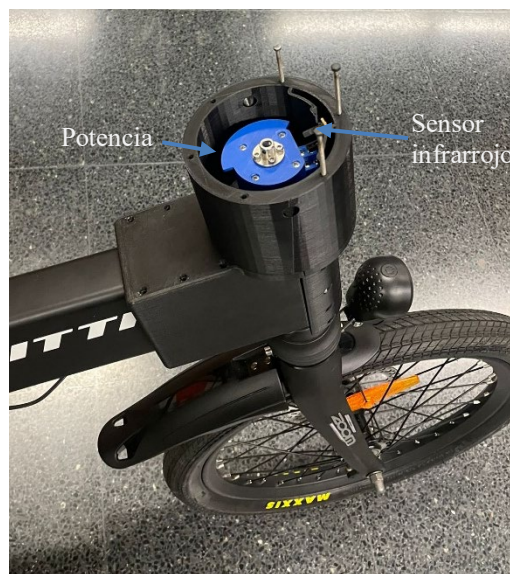
Figura 3: Potencia (en azul) con la pestaña empleada para la referencia de ángulo de dirección, en combinación con el sensor infrarrojo, que se ve en la parte delantera.
